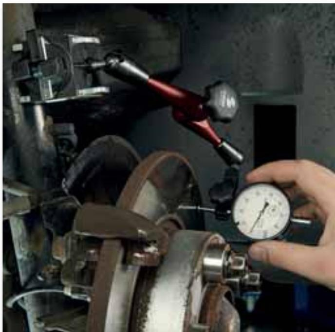
**An Bremsscheiben ist Verschleiß häufig auch für Autofahrer gut zu erkennen, der Rundlauf der Scheiben dagegen nicht. Bei Bedarf wechselt die Fachwerkstatt die Scheibe aus.**
